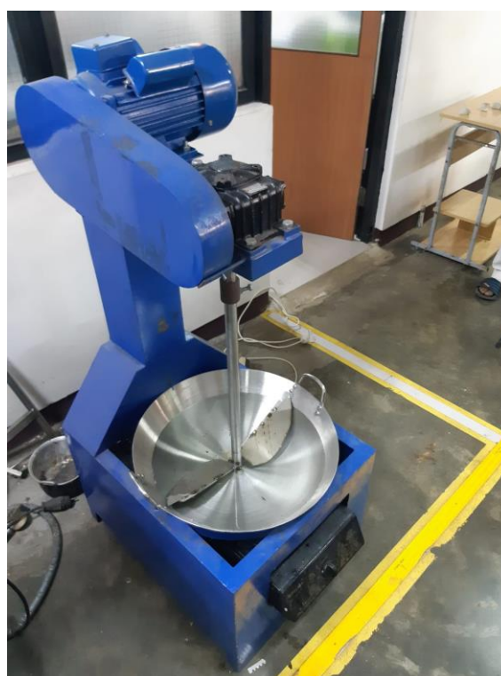
(a) (b) Gambar 6. Desain dan alat pengaduk yang dihasilkan
